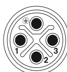
Esquema polos conector M12, 4 polos, codificado S, vista cara pines
